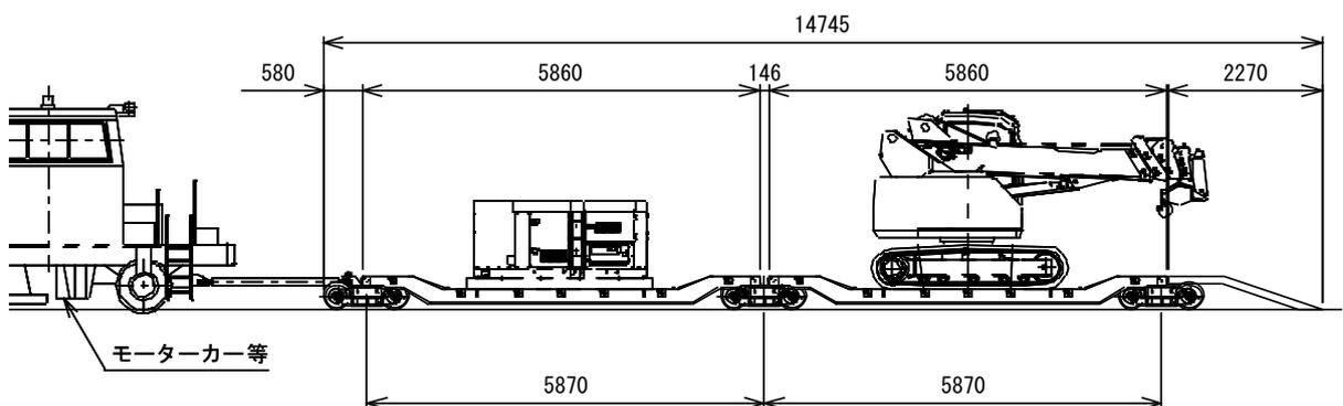
台枠2台+搭載用ランプウェイ接続時
