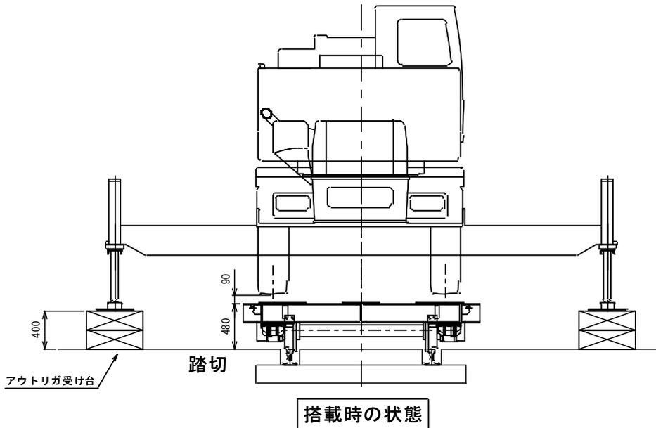
●台車へはクレーンのアウトリガを利用して搭載
